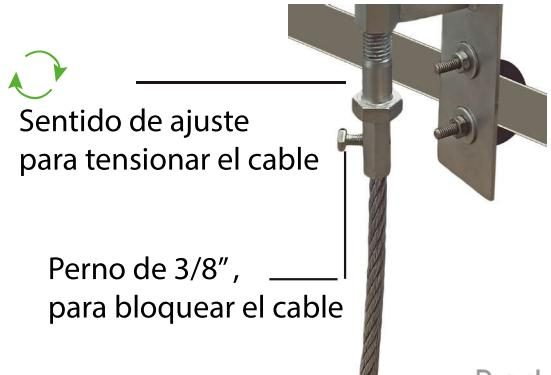
Sentido de ajuste para tensionar el cable
