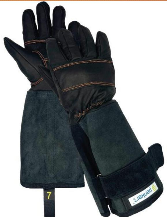
El guante de protección para bomberos BASIC GRIP 3.0 LONG está especialmente diseñado para la extinción de incendios. Ofrece una excelente comodidad y una gran sensibilidad táctil gracias a su piel de vacuno termorresistente e hidrófoba y al refuerzo adicional en la palma. El puño del antebrazo, fabricado en serraje de vacuno termorresistente e hidrófobo, proporciona protección adicional.
