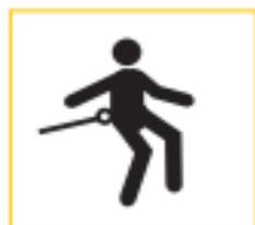
La anilla se utiliza junto con una línea de conexión para la restricción del movimiento
