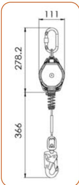
La línea de vida retráctil forma parte del sistema anticaídas y reduce la fuerza de impacto vertical sobre el cuerpo al limitar la distancia de caída. ¡Este dispositivo es para una sola persona!
