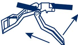
UNA VEZ LIBERADA LA CINTA, TOMA EL MANGO MAYOR DEL TRINCAJE Y CON MOVIMIENTOS HACIA ADELANTE Y HACIA ATRÁS PROCEDA A TENSIONAR LA CINTA MAYOR DE LA LÍNEA.
