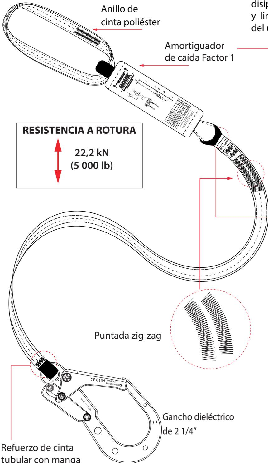
El amortiguador de caída esta diseñado para disipar la energía generada durante una caída y limitar la fuerza de impacto sobre el cuerpo del usuario.
