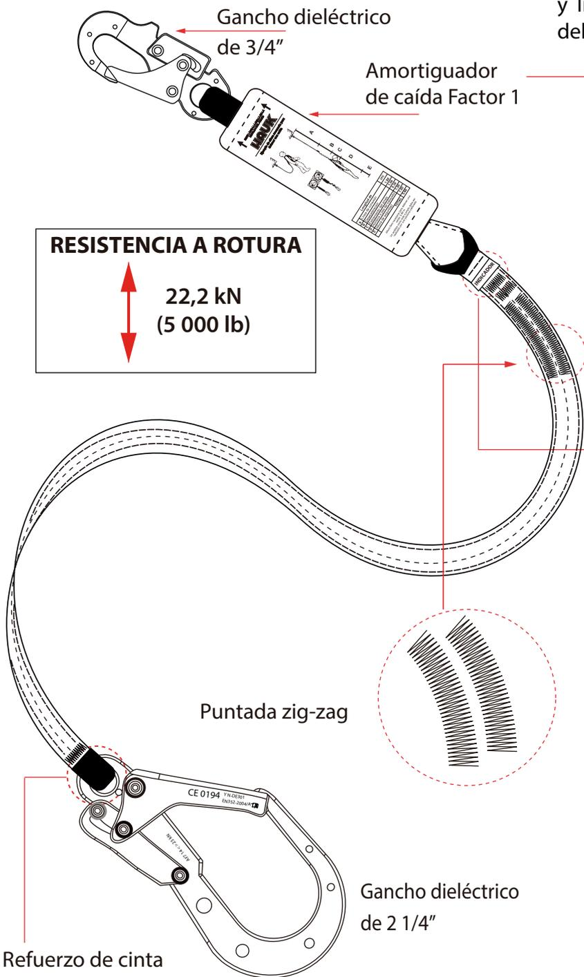
El amortiguador de caída está diseñado para disipar la energía generada durante una caída y limitar la fuerza de impacto sobre el cuerpo del usuario.
