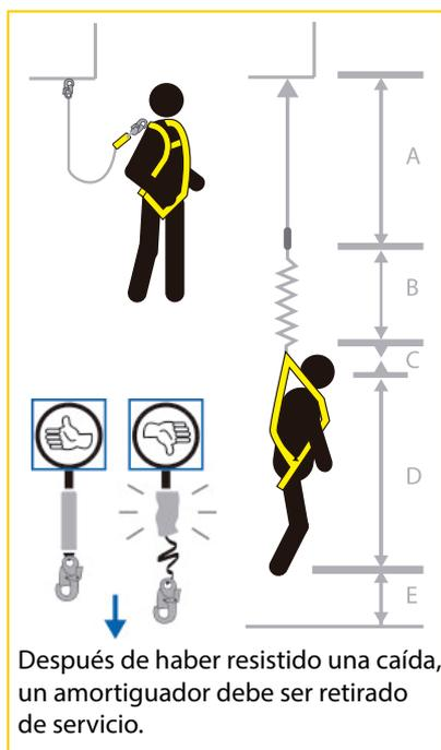
Ejemplo del cálculo de altura libre requerida para detener una caída de factor 1
