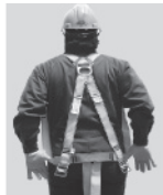
3. Colóquese el arnés como si fuera un chaleco; la anilla "D" debe quedar en la espalda y al centro de los hombros.
