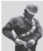
3. Abroche las hebillas que cuelgan a la altura de las piernas y proceda a regular.
